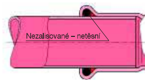
obr. 2: řez nelisovaným spojem SANHA® tvarovky
