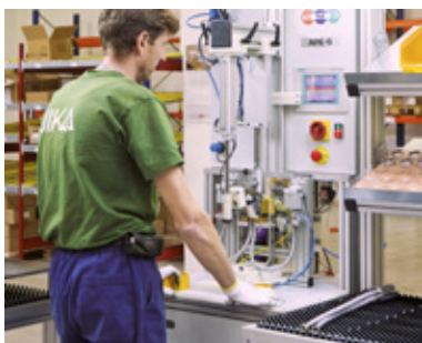
Vzduchový test na montážní lince.
