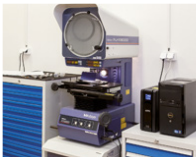
Profilový projektor. Laboratoř oddělení kvality.
