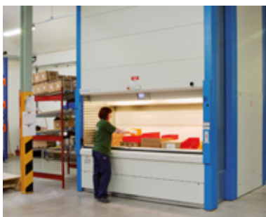
KARDEX. Velkokapacitní automatizovaný skladovací systém.
