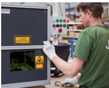
Laser při procesu vypalování loga.
